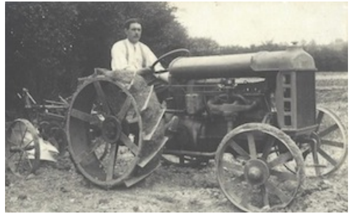
Ce tracteur présente les caractéristiques du modèle Ford des années 1917 – 1930 : 4 roues acier, tôle sur le devant.
